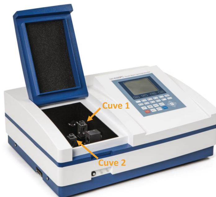
Figure 81 : Spectrophotomètre à deux cuves (© VWR).
